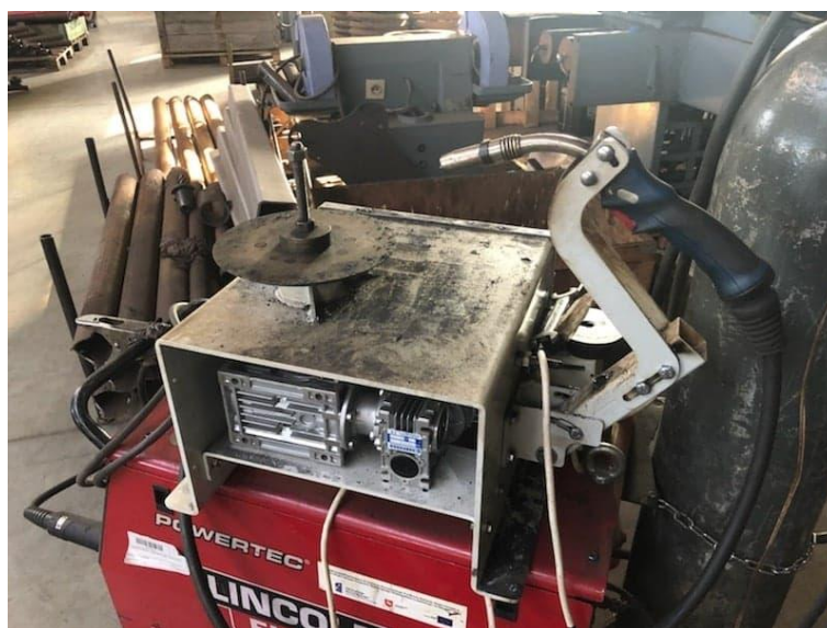
Rys. 3.5. Obrotnik spawalniczy w warunkach warsztatowych [oprac. własne]
