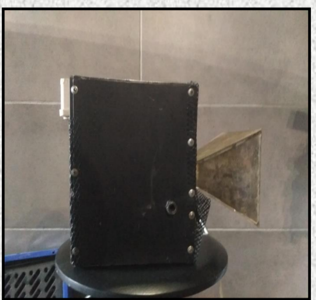
Fot. 3. Antena tubowa - składa się z magnetronu wytwarzającego fale elektromagnetyczne o częstotliwości 2450 MHz i mocy 800.
